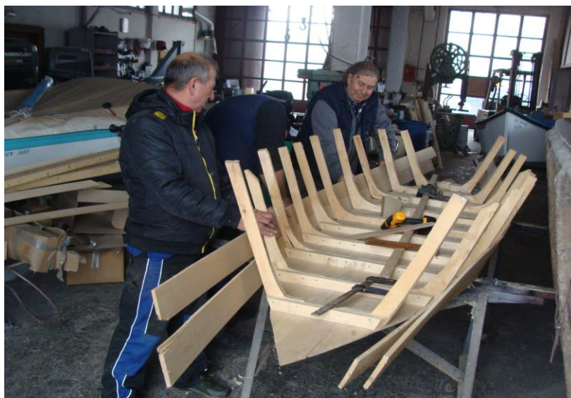
Εικ. 16: Το κάρφωμα των στραβόξυλων στους νομείς.
