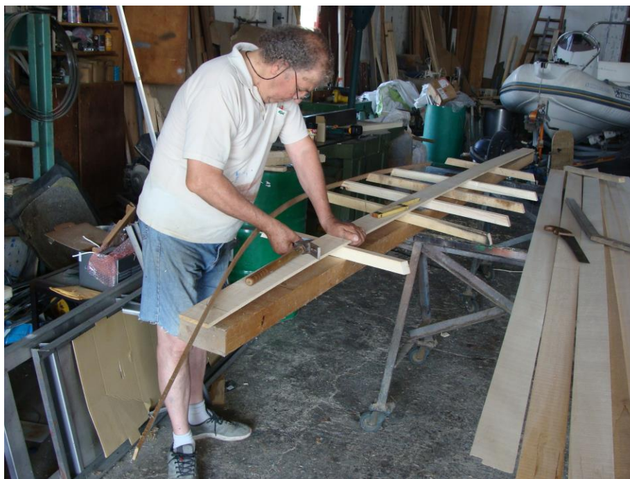
Εικ. 13: Η κατασκευή του πυθμένα της πλάβας Αξιού από τον ξυλωναυπηγό Νικόλαο Δημούδη.
