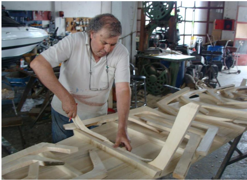
Εικ. 15: Κατασκευή νομέων της πλάβας Αξιού με τη χρήση χναριού από τον ξυλοναυτηγό κ. Νικόλαο Δημούδη.
