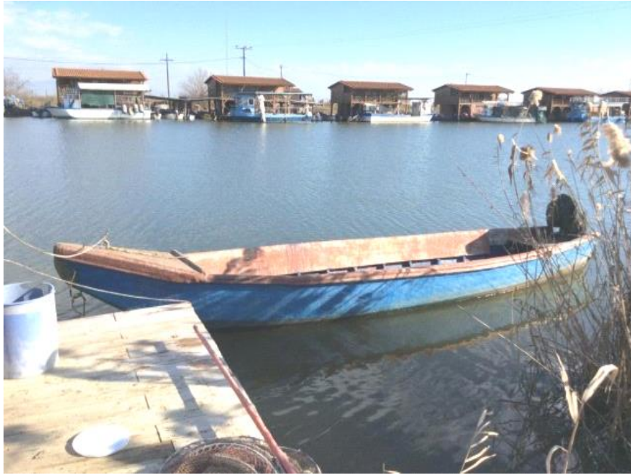
Εικ. 11: Πλάβα στον Αξιό ποταμό, η οποία έχει μετασκευαστεί στην πρόμνη για να φέρει εξωλέμβια μηχανή
